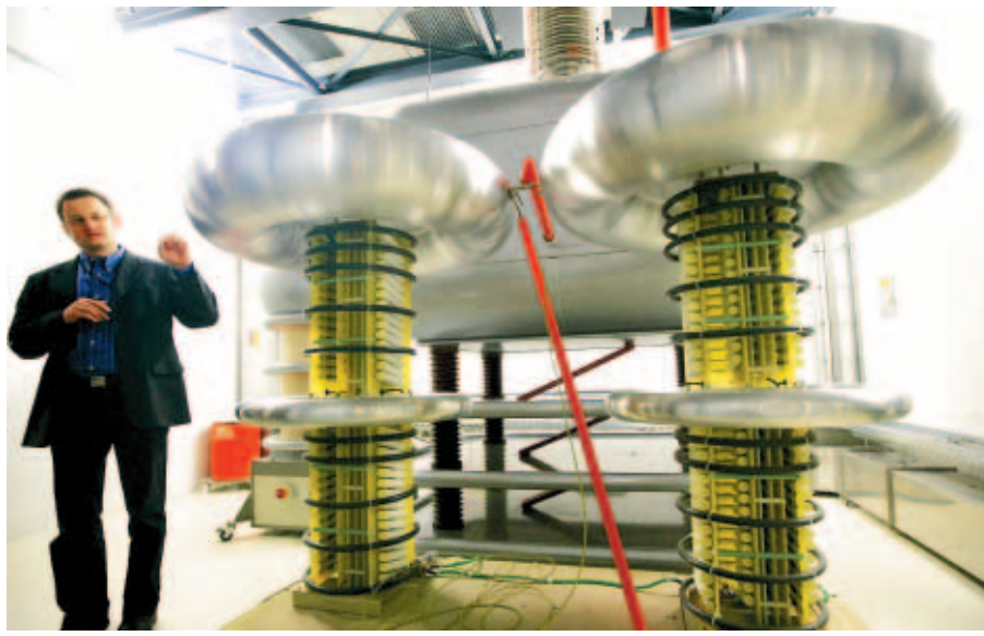
Willkommen auf der „Enterprise“! Dr. Andreas Wagner erläutert im Neutronenlabor Rossendorf eine Beschleuniger-Anlage, die Deuterium-Kerne mit Spannungen von 200 000 Volt beschleunigt und zur kalten Fusion mit Tritium zwingt. Foto: Oliver Killig
